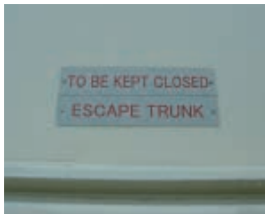
一般名称板〔暴露部〕 材質：SUS304 1.0t
